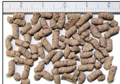
写真-1 継手管充填材
